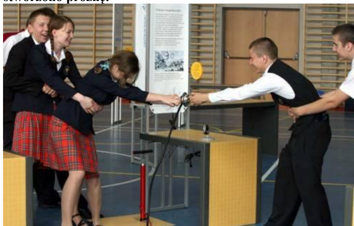
Zdjęcie 18: Pokaz w wystawy Eksperymentuj! Próba rozerwania kuli złożonej z dwóch półkul wewnątrz której stworzono próżnię.
